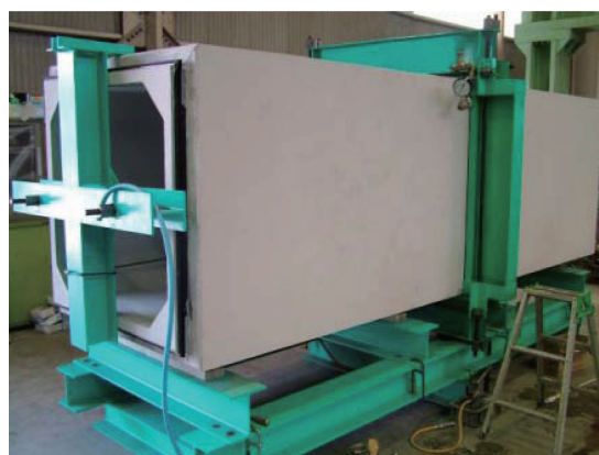
継手部水密性能試験 (ゴムリング方式)
